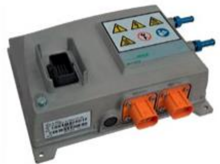
Liquid cooled HVLP-20 (乾燥重量 2.3kg) ※6L/minの水量で内部温度70℃まで動作可能
