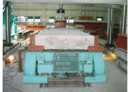
繰り返し荷重載荷 (200万回) 試験状況
